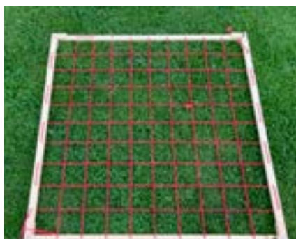
Abb. 1: Schätzrahmen zur Prüfung des Deckungsgrades mit der Größe 1 x 1 m nach DIN EN 12331.
