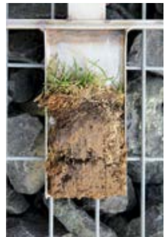
Etwas „verunglückte“ Profilsparren-Probe „nach“ der Bodenbearbeitung – deutlich zu erkennen: der erhöhte Sandanteil.
